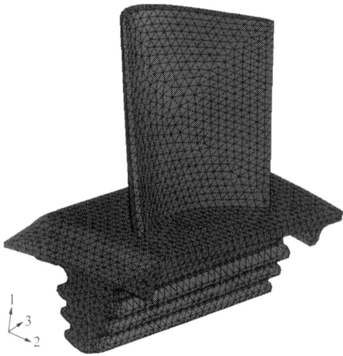
图 1 某发动机涡轮叶片有限元网格 Fig.1 Finite element mesh of a turbine blade
